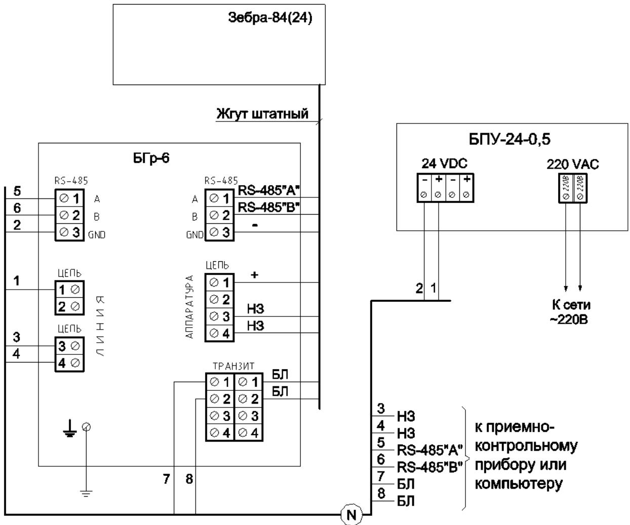
Рисунок – 2.6 Схема подключения извещателя при использовании блока грозозащиты «БГр-6».
